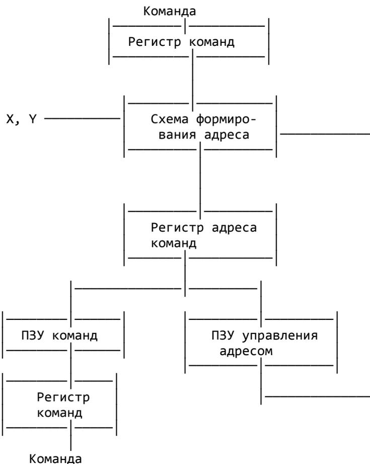
Общая структура программных управляющих устройств показана на схеме выше. Коды всех команд хранятся в ПЗУ микрокоманд. Выбор требуемой команды определяется ее адресом, который образуется с помощью схемы формирования адреса команд, функции которой в микропроцессоре обычно выполняются микросхемами. В соответствии с кодом поступившей команды, хранящемся в регистре команд, схема формирует адрес первой из
