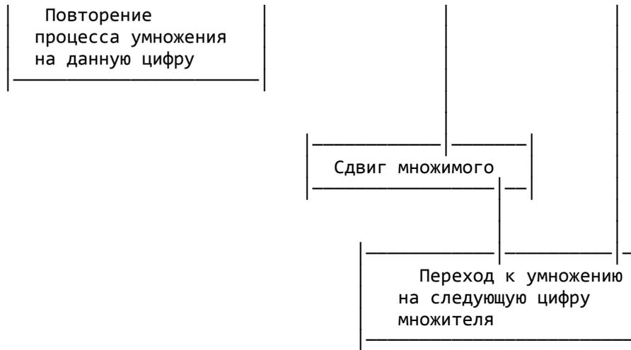
Таким образом, автоматическая вычислительная машина, реализующая алгоритм умножения, должна содержать: два приемных регистра, сумматор со сдвигом, регистр результата, счетчик и коммутатор управления (схема сравнения, переключатель).
