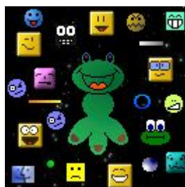
Первая картинка, выведенная на LCD Параметры: 132x132 pix, 4096 цветов (12 bit) Рисовалась \approx 3 секунды
