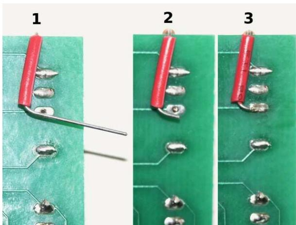
После припаивания всех диодов, нужно прозвонить каждый и удостовериться, что ток через диод течёт только в одну сторону - если на каком-то из диодов ток течёт в обе стороны, значит средняя ножка всё таки коснулась своей контактной площадки и закоротила диод - переключатель придётся перепаивать.
