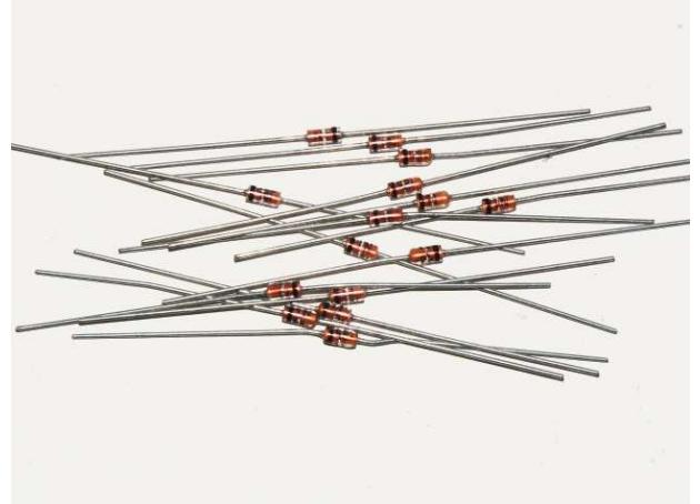
Диоды надо припаять между средней ножкой каждого переключателя и тем местом куда она должна была втыкаться - именно поэтому мы в самом начале средние ножки переключателей загибали и припаивали к металлическому корпусу - чтобы затем припаять диод туда же. Для этого надо отрезать вывод идущий от анода на расстоянии примерно 5 мм от диода, а со стороны катода (там где чёрная полоска) надеть на вывод резиновую трубку длиной около 10 мм:
