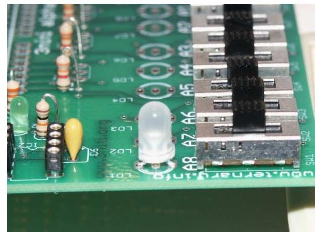
С установленными светодиодами плата будет выглядеть так:
